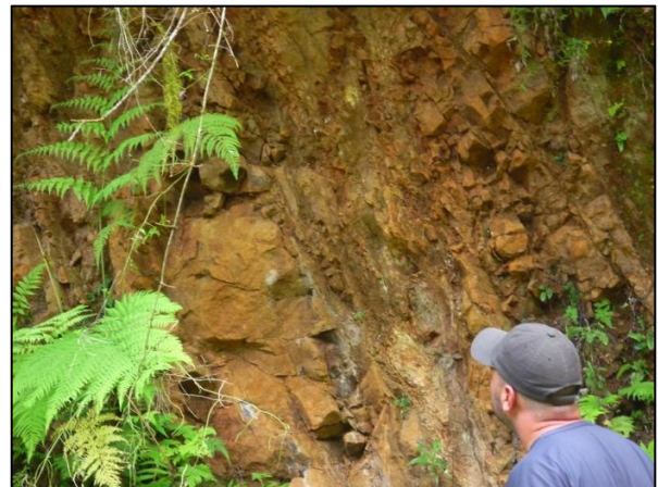
Foto 55: Detalhe do Horizonte C, composto por rochas com grau médio de alteração, em exposição de Neossolo Litólico no ponto PR 21 do Perfil Geológico.
