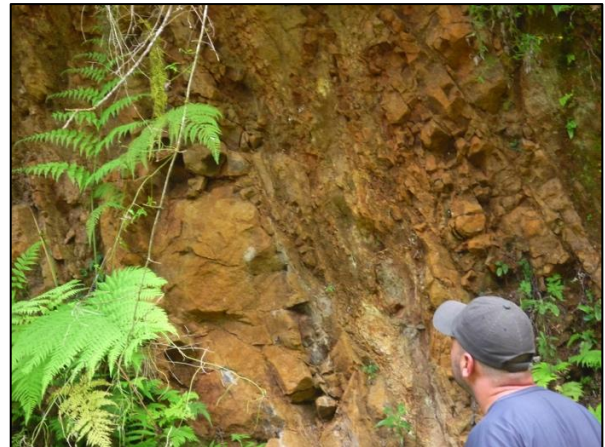
Foto 39: Detalhe da presença de brecha de falha de cerca de 50 cm de espessura, em meio ao substrato basáltico de estrutura maciça. A linha amarela indica a orientação da falha.
