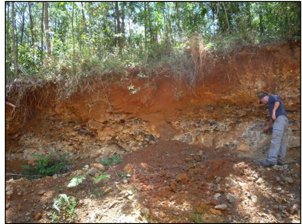
Foto 37: Perfil de alteração de basalto em saibreira situada à margem da via no ponto PR 22 do perfil geológico. Na base do perfil encontram-se preservadas a textura e a estrutura da rocha.
