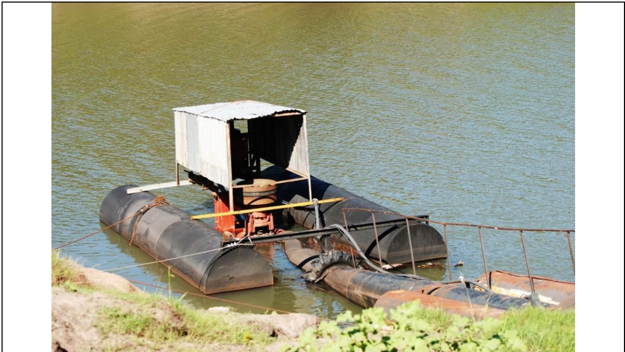
Figura 6.3-26 Bomba d'água que abastece lavoura de arroz, às margens do rio Quaraí. Foto: Cristiano Rovedder.
